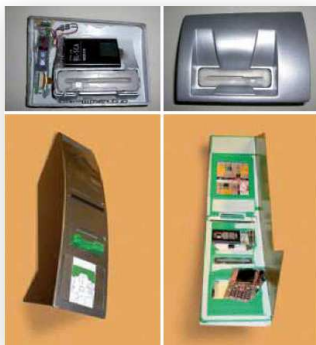
Manipulierter Karteneinschub mit Magnet- streifenleser
