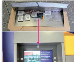
Handykamera in Blende zum Filmen der Tastatureingabe
